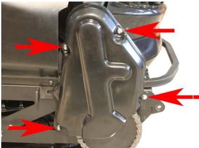
2. Ослабляем два болта и сдвигаем натяжник до упора вперед.
