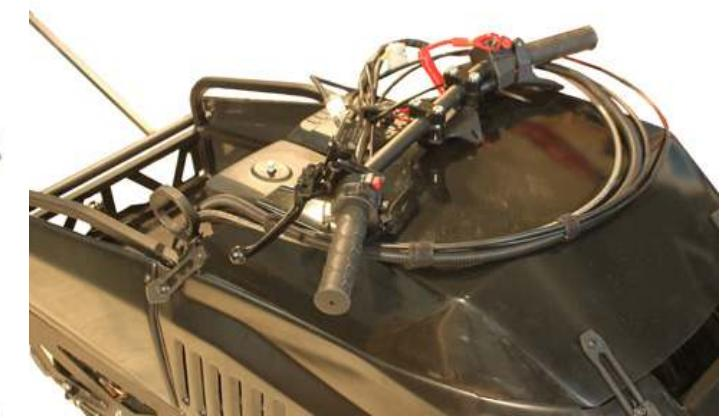
7. Откручиваем болты крепления рулевой стойки и снимаем её.
