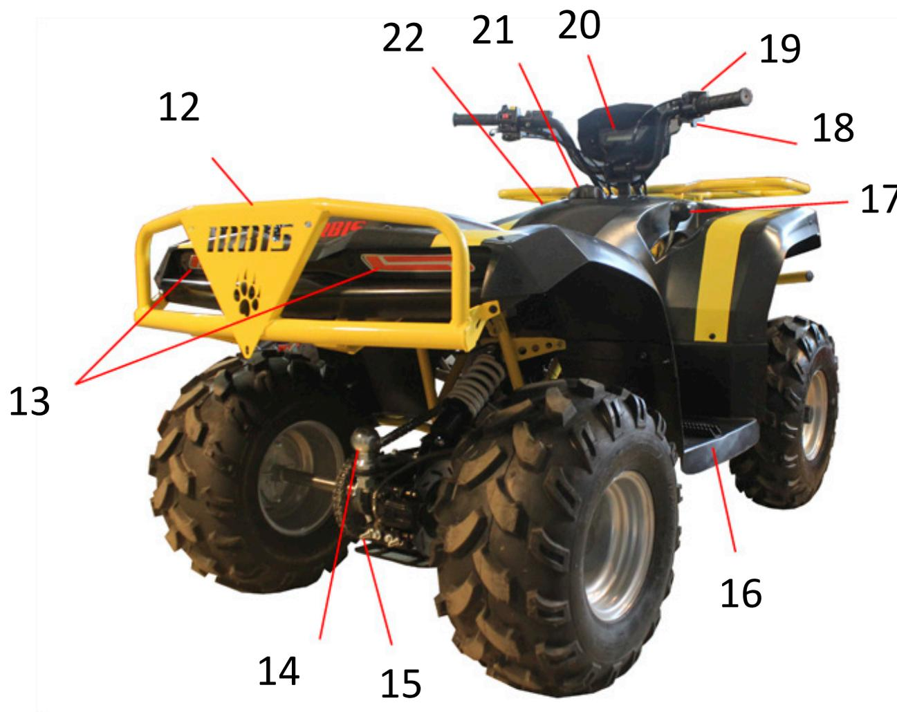
12. Место крепления номерного знака; 13. Фонари задних габаритных огней и стоп-сигнала; 14. Фаркоп; 15. Натяжитель цепи; 16. Подножка правая; 17. Рычаг переключения режимов трансмиссии; 18. Рычаг передних тормозов; 19. Курок газа; 20. Приборная панель; 21. Крышка бензобака; 22. Замок зажигания, розетка 12В.
