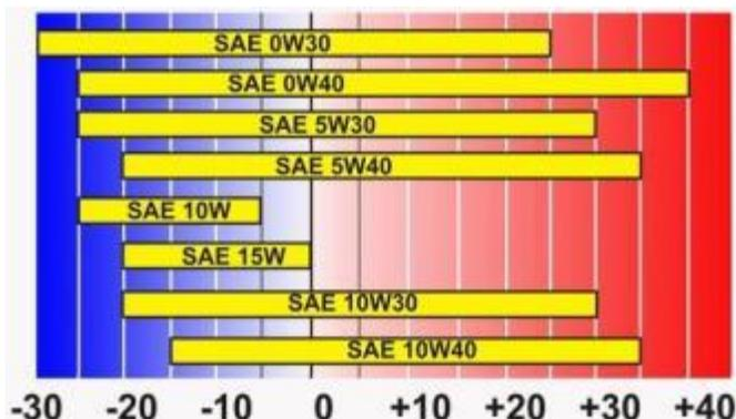
На заводе квадроцикл заправлен **транспортровочным** маслом для бензиновых двигателей марки SAE 10W30 API SF-CC. Перед началом эксплуатации необходимо заменить масло. Рекомендуется использовать масло, специально предназначенное для четырехтактных двигателей. Вязкость масла можно выбрать в соответствии с климатом согласно приведенной схемы.
