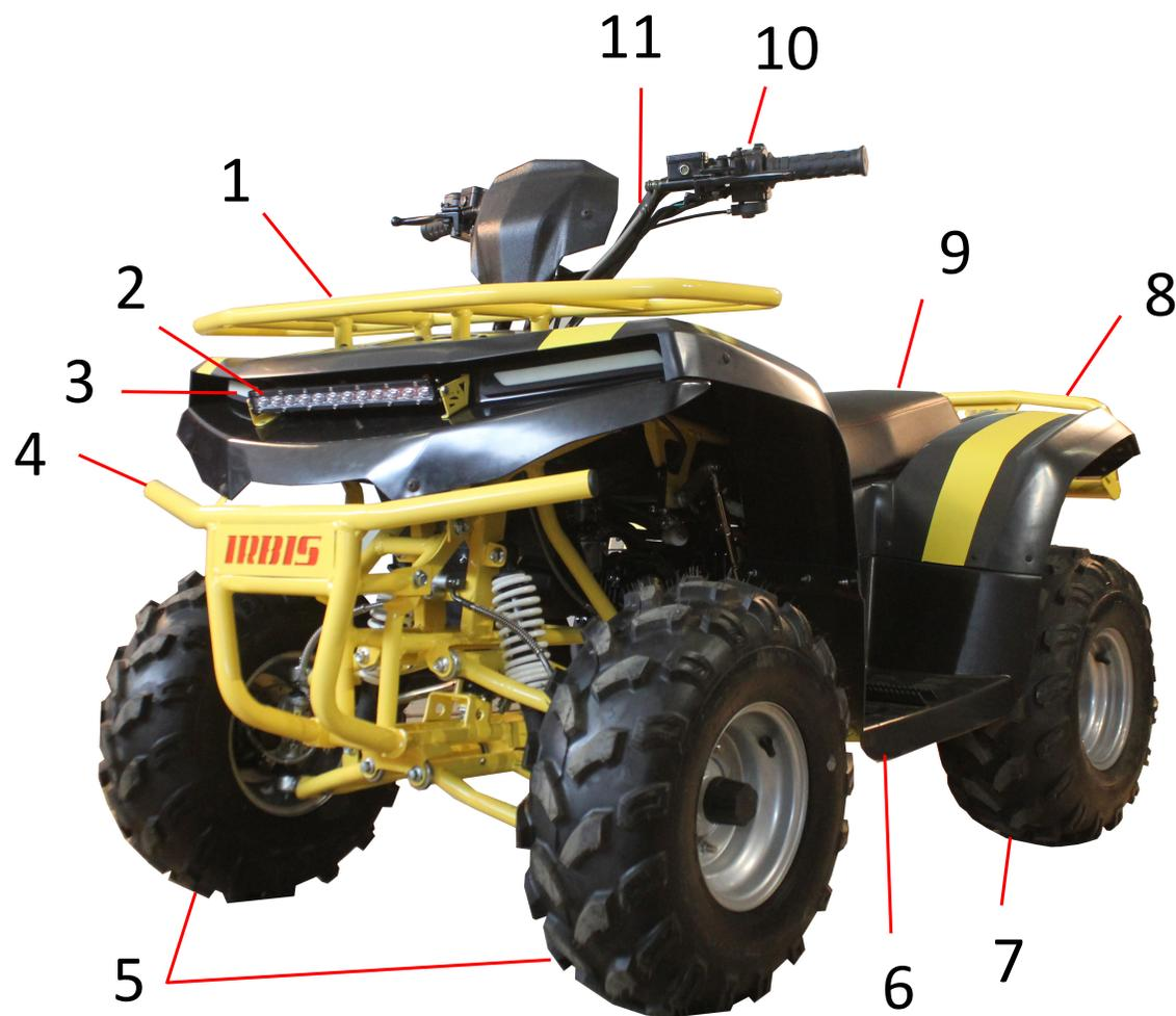
1. Передний багажник; 2. Фара головного света; 3. Габаритные огни; 4. Передний бампер; 5. Передние колеса; 6. Подножка левая; 7. Задние колеса; 8. Задний бампер; 9. Сиденье; 10. Рычаг заднего тормоза; 11. Руль.
